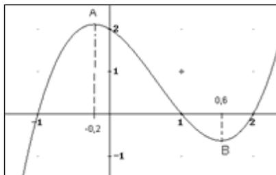
Si seguimos con el dedo la gráfica de la función del dibujo de izquierda a derecha, vemos que vamos subiendo hasta llegar al punto A luego bajamos hasta llegar al punto B y a continuación volvemos a subir. Diremos que la función crece hasta el punto A y del B en adelante. Del punto A al B la función disminuye y por tanto decrece.
