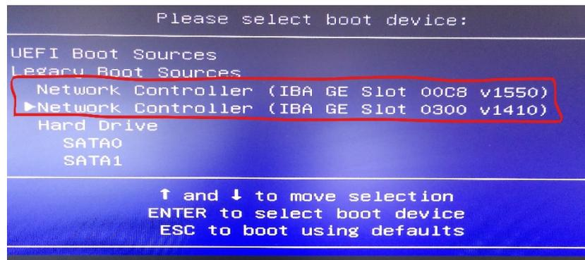
Si te fijas las pizarras SIATIC tienen **dos tarjetas de red**. Con las teclas del cursor nos ponemos en una de las tarjetas de red. (en mi caso la segunda) y pulsamos la **tecla Enter**. Si el proceso no funciona probar a seleccionar la segunda tarjeta de red.
