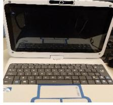
Para arrancar por red las portables INVES (blancas) tienes que conectar **internet por cable** el portátil y encenderlo pulsando la **tecla F11**. Nos tiene que salir en pantalla la siguiente imagen
