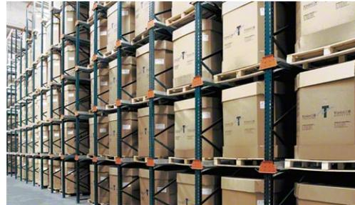
Este sistema de almacenaje por compactación está compuesto por un conjunto de estanterías, que forman calles interiores de carga, con carriles de apoyo para las paletas. Las carretillas penetran en dichas calles interiores con la carga elevada por encima del nivel en el que va a ser depositada.
