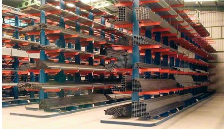
Creada para almacenar barras, perfiles, tubos, maderas y unidades de carga de gran longitud y peso. Esta estantería posibilita la manipulación de la carga mediante elementos de elevación como puentes grúa, transelevadores, carretillas elevadoras, etc., elegidos en función de la mercancía a depositar, principalmente por su peso, medidas o por la altura de la propia estantería.
