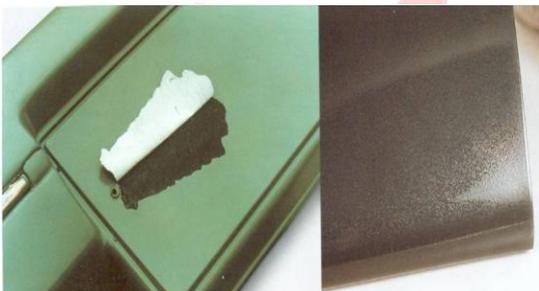
Falta de adherencia debido a una limpieza insuficiente o al uso de promotores no apropiados.
