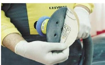
Mediante discos autoadhesivos, de un solo uso, (stikit).
