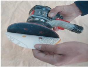
Mediante un sistema tipo "velcro", el plato está provisto de ganchos en forma de hongos que se adhieren al terciopelo del soporte del abrasivo.
