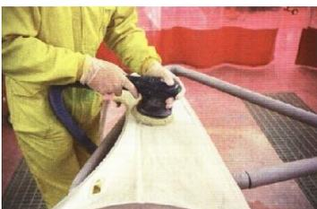
Lijado en seco y a máquina
