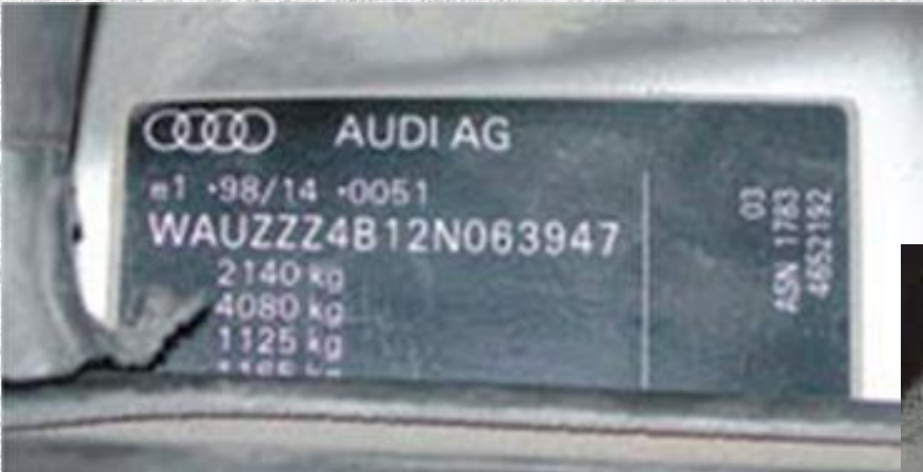
Figura 1.27. Número VIN en la placa del fabricante.
