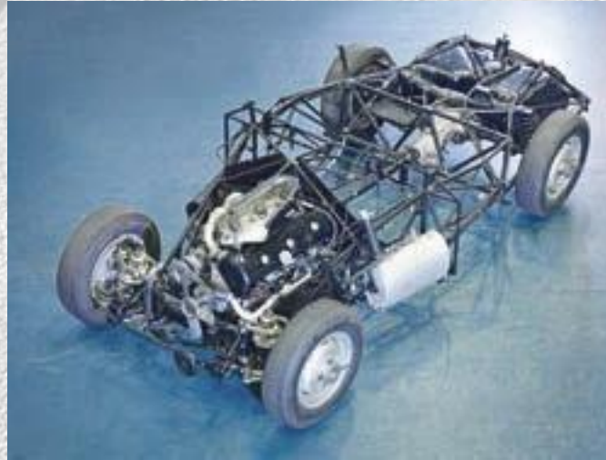
Figura 1.13. Chasis tubular con órganos mecánicos de un vehículo deportivo clásico.
