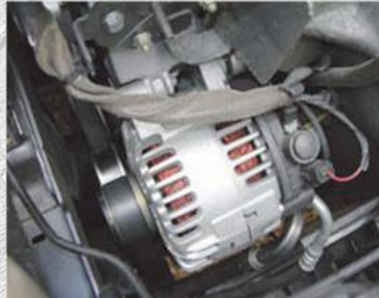
Figura 1.18. Alternador del sistema de carga de un turismo.
