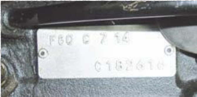
Figura 1.30. Placa del número de motor.
