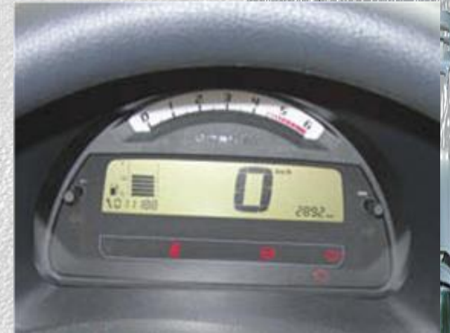
Figura 1.19. Cuadro de instrumentos digital.
