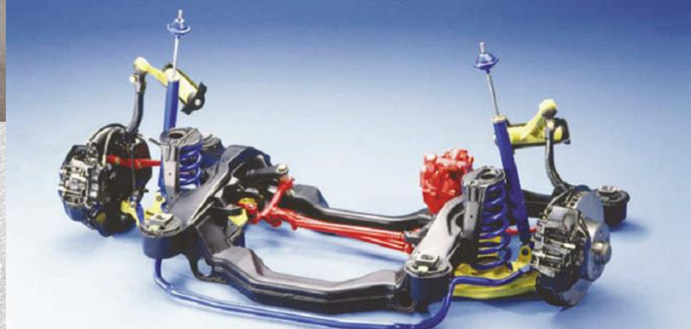
Figura 1.15. Semichasis con los elementos de suspensión, dirección y frenos montados.
