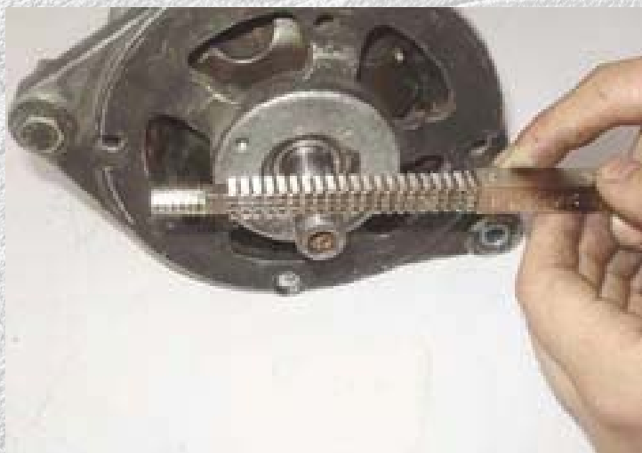
Figura 2.54. Repaso de la roscas de un alternador.
