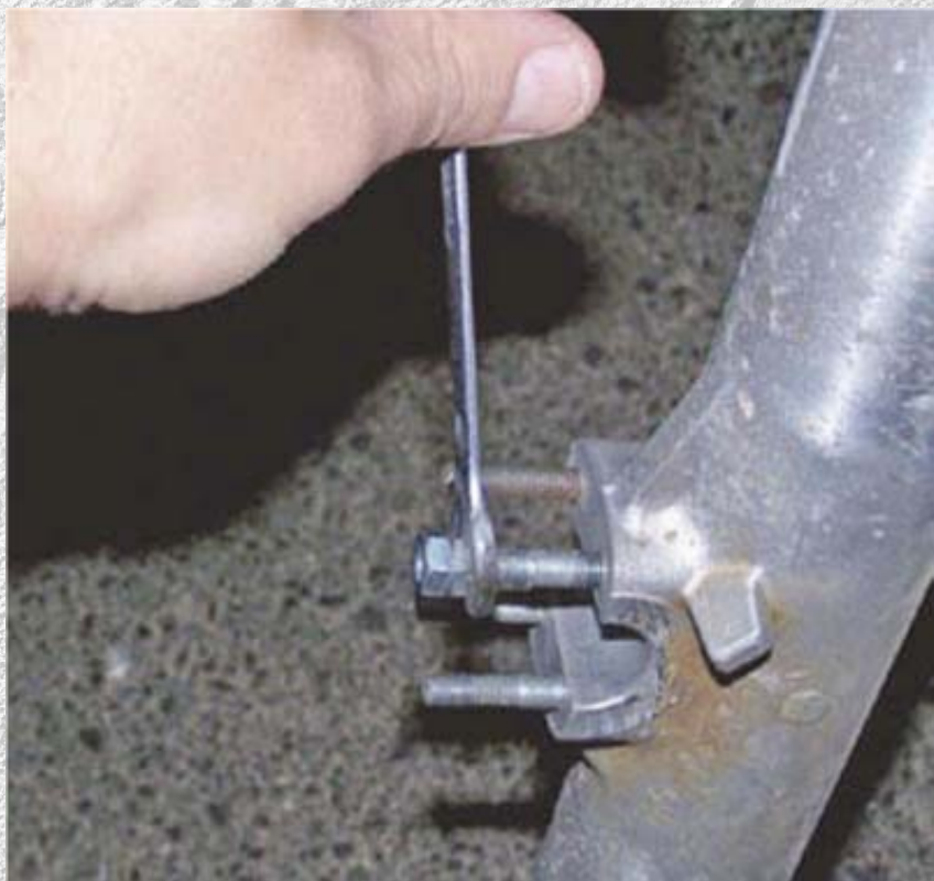
Figura 2.56. Extracción con dos tuercas.
