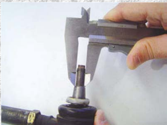
Figura 2.17. Medida del diámetro exterior.
