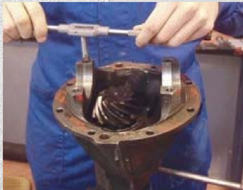
Figura 2.59. Reparación de una rosca con el macho de roscar.
