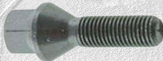
Figura 2.24. Tornillo de rueda con asiento cónico.
