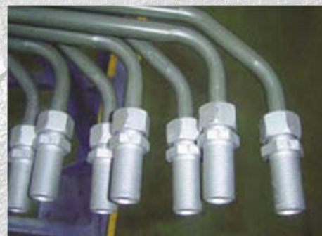
Figura 2.5. Racores con rosca gas.
