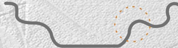
Hump externo de la rueda (código H) para neumáticos Tubeless (sin cámara de aire)
