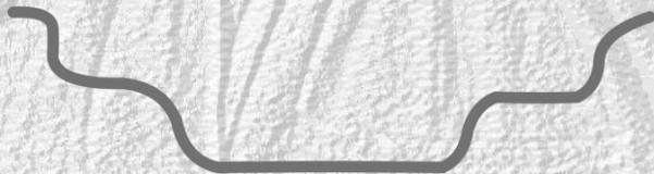
Estándar para neumáticos Tube Type (con cámara de aire)
