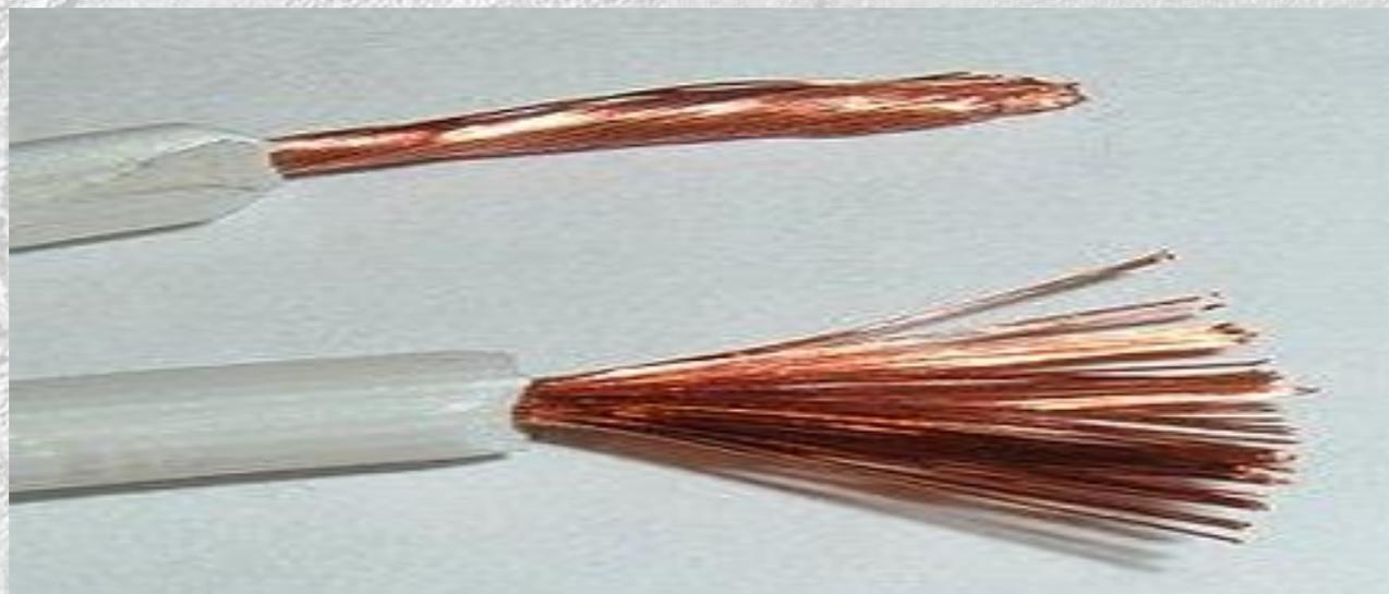
Un **conductor eléctrico** es un material que ofrece poca resistencia al movimiento de la carga eléctrica. Sus átomos se caracterizan por tener pocos electrones en su capa de valencia, por lo que no se necesita mucha energía para que estos salten de un átomo a otro.
