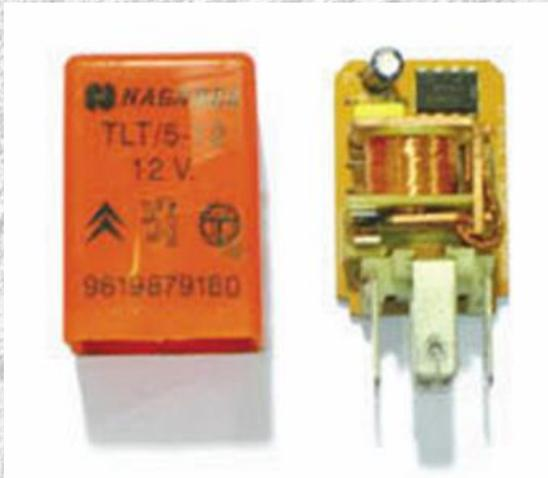
El **relé** (en francés, *relais*, “relevo”) o **relevador** es un dispositivo electromagnético. Funciona como un interruptor controlado por un circuito eléctrico en el que, por medio de una bobina y un electroimán, se acciona un juego de uno o varios contactos que permiten abrir o cerrar otros circuitos eléctricos independientes. Fue inventado por Joseph Henry en 1835.
