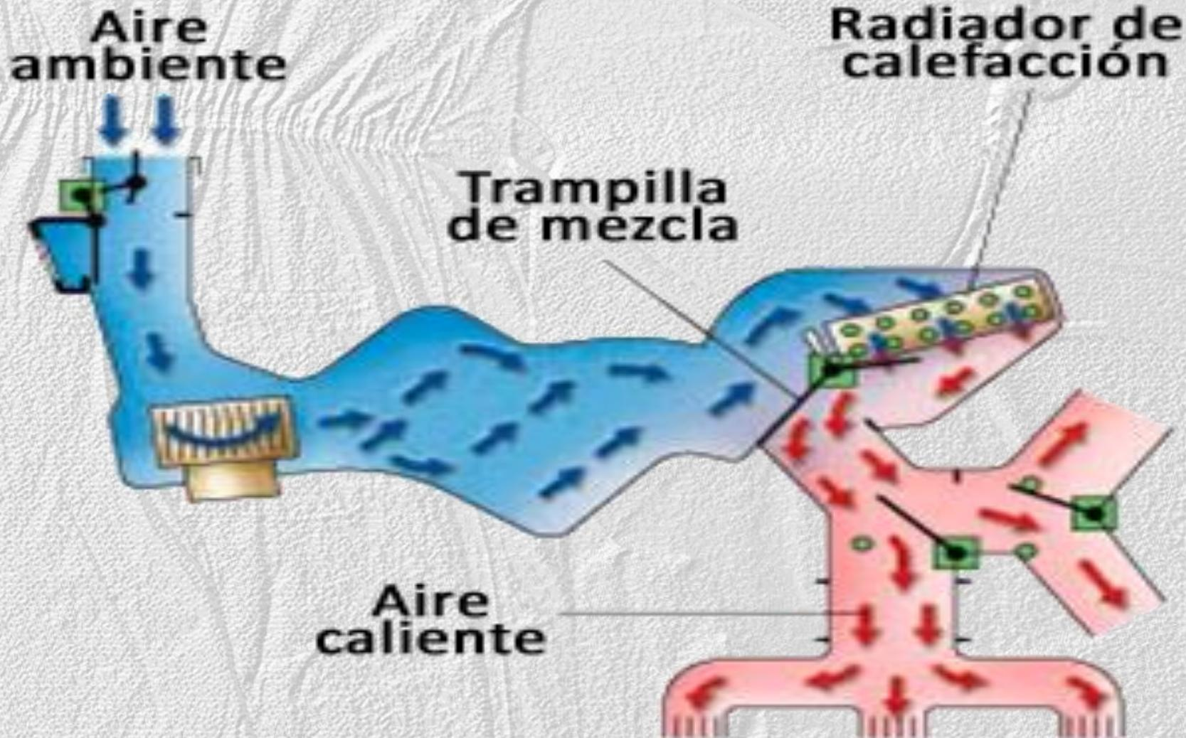
Figura 11.16. Distribución del aire según la posición de las trampillas.
