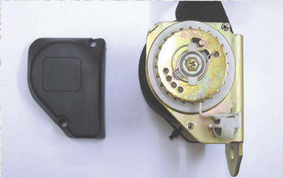
Figura 12.12. Mecanismo de bloqueo del cinturón.
