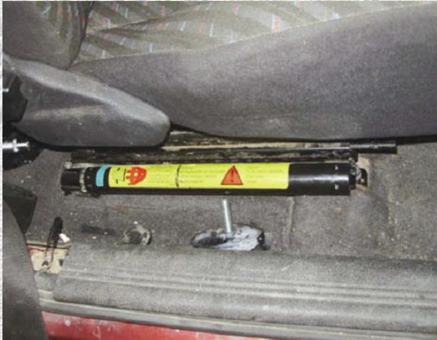
Figura 12.14. Señalización del pretensor mecánico.
