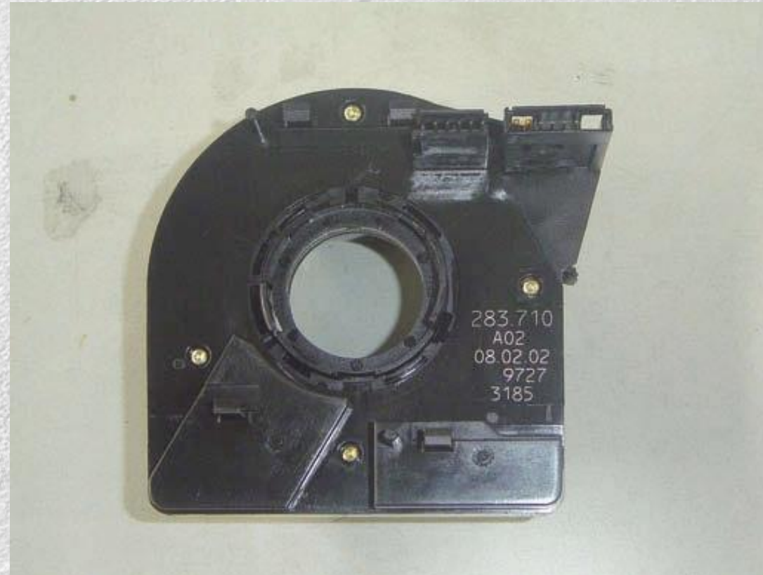
Figura 12.5. Captador de giro y muelle en espiral desmontado.
